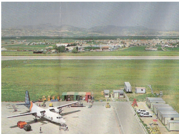
Het "Fokkerdorp" aan de rand van het platform van het vliegveld te Granada. Al het benodigde was er: werkplaats, magazijn, kantoorkaart, telemetrie grondstation, snelle dataverbinding met de centrale computers bij NLR en Fokker, eigen stroomvoorziening, eigen telefoonlijnen, toiletgebouw, etc.. Op de achtergrond de startbaan waarop de metingen werden gedaan.
